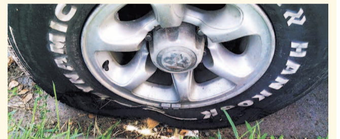
НА ФОТО: ШИНА РЕМОНТУ НЕ ПОДЛЕЖИТ
